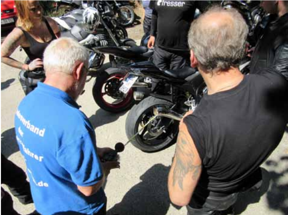
Michael Wilczynski (l.) misst beim Aktionstag in Sundern mit dem Schallpegelmessgerät die Lautstärke eines Motorrads.
