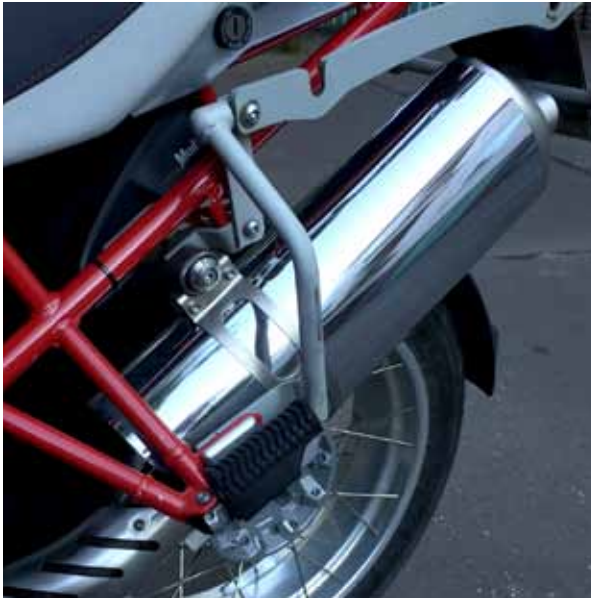
Der neue alte Auspuff. Nur Profis erkennen, dass es sich um den angepassten Endschalldämpfer des Vorgängermodells handelt. (Foto: Aufderheide)
